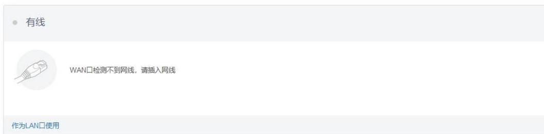
将网线插入到路由器 WAN 端口，连接信息将显示在网线部分，DHCP 是默认协议，您可以点击修改来更改协议。
