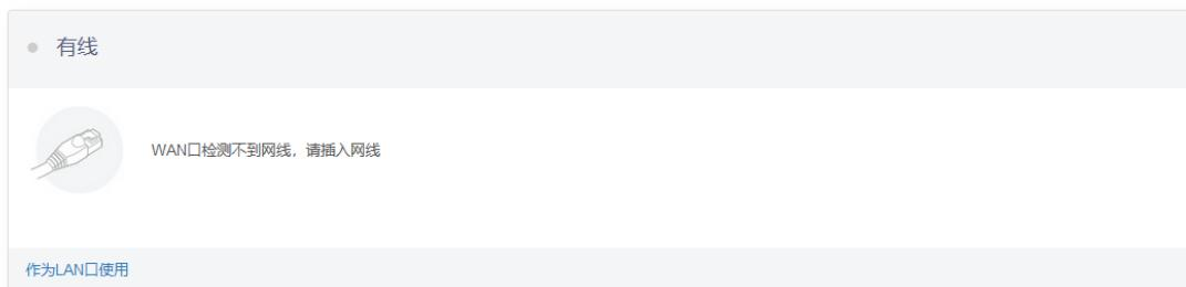
将网线插入到路由器 WAN 端口，连接信息将显示在网线部分，DHCP 是默认协议。
