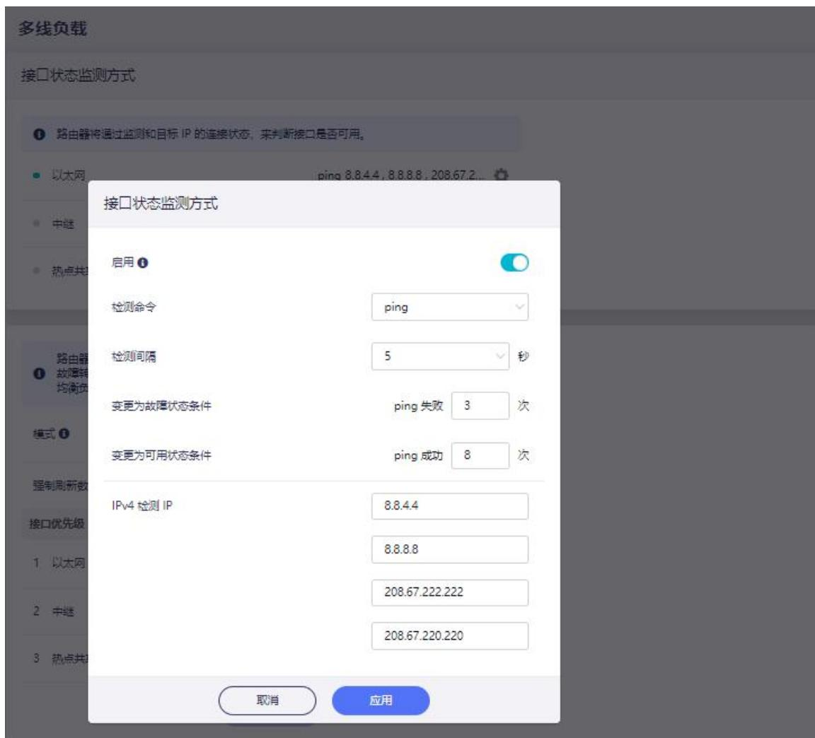
**故障转移:** 当正在使用的接口故障时，路由器会自动切换到另一个接口。
