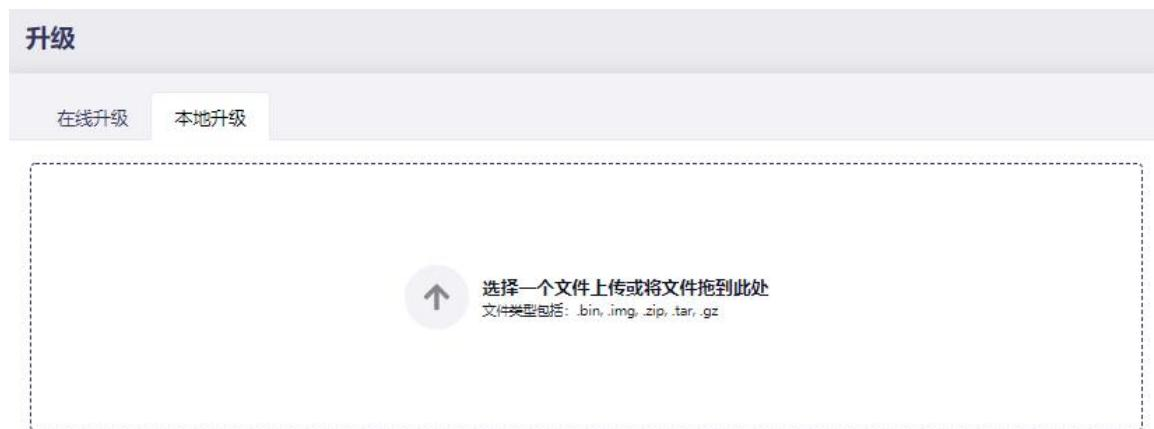
\*注意本地升级仅支持 GL.iNet 官方固件及基于 GL.iNet 官方源码自编译固件升级。
