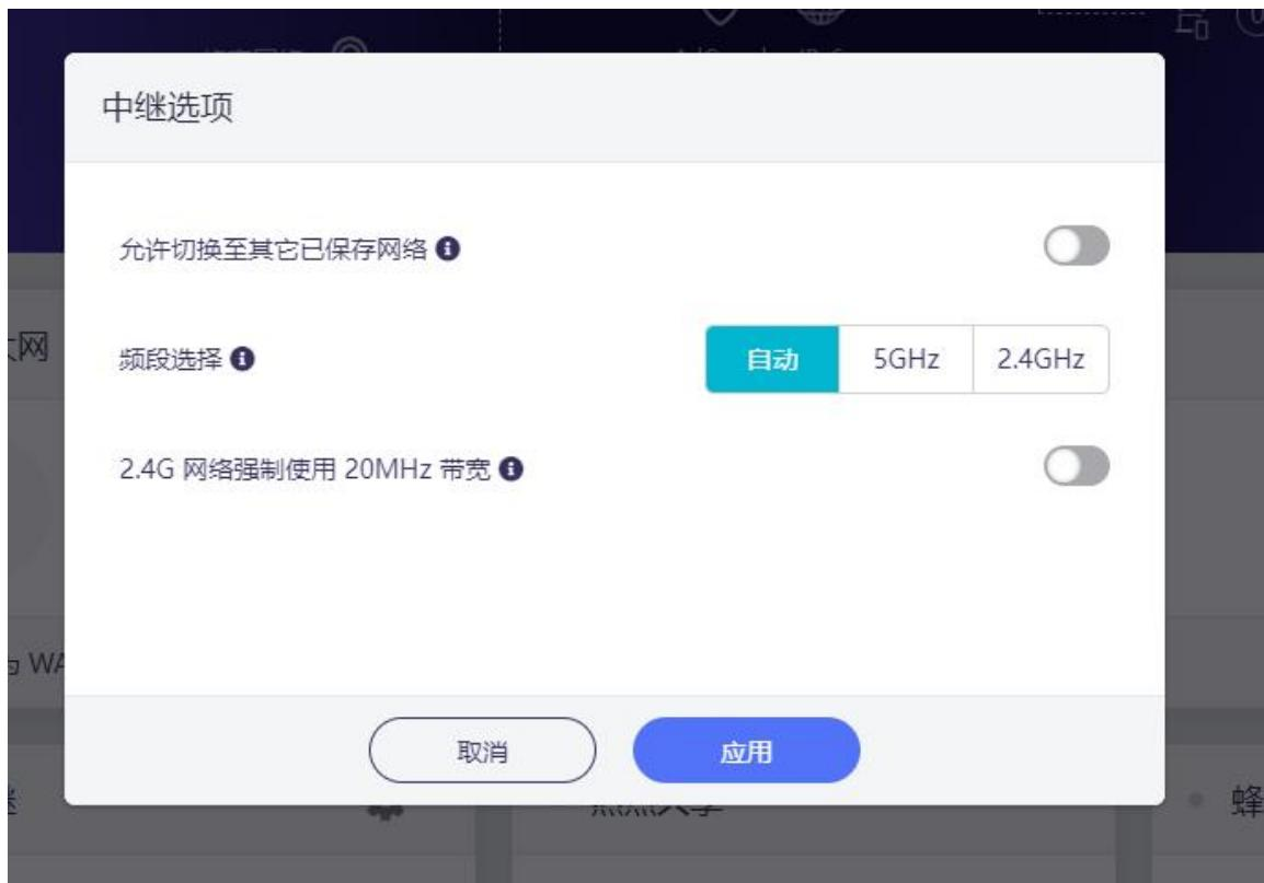
允许切换至其他已保存网络：若此选项启用，在无法连接到当前连接的 Wi-Fi 时，路由器将尝试连接其它已保存的网络。
