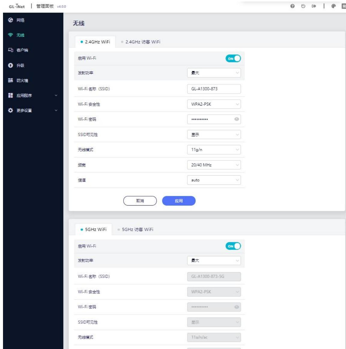
点击**修改**以更改无线网络的设置，点击**应用**以完成无线网络的设置。
